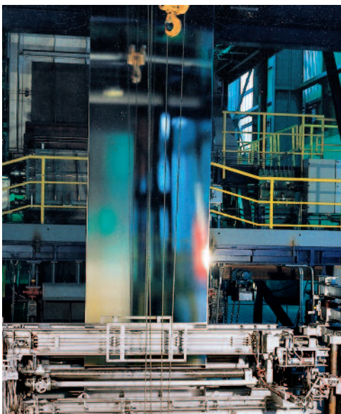
Band nach Verlassen des Zinkkessels und Passieren der Abstreifdüsen
