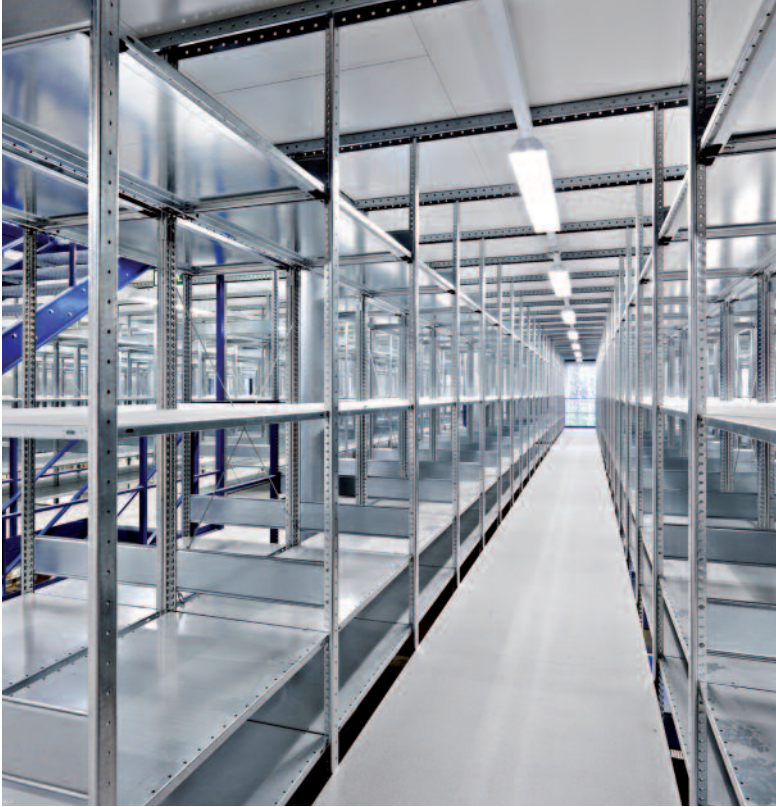
Hochregallager: Stützen und Böden aus Feinblech mit Zink-Magnesium-Überzug
